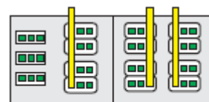
Рис. 2. а) Схема выпрямителя и инвертора; б) план расположения модулей на радиаторах с горизонтальной (2H) конструкцией 2-х «кубиков»
